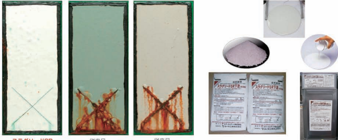
スラグリードSR 従来品 (アルカリ塗料) 従来品 (エポキシ樹脂系塗料)
